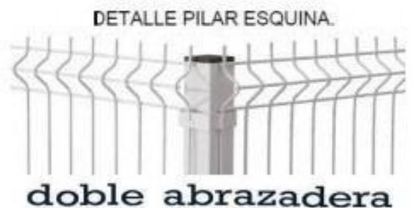
Detalles para la fijación de paneles a pilares.
